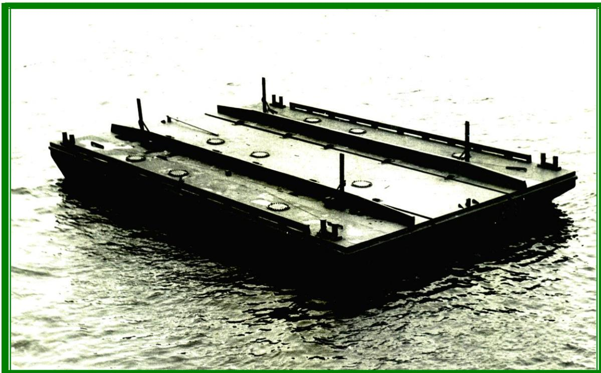
Для ограничения штабеля по длине на плашкоуте установлены упорные откидные стойки. Конструкция упорно-откидных стоек спроектирована так, что предотвращает самопроизвольную раскатку бревен. Для надежности стойки закреплены тросом, который удерживается замком. Замок легко открывается от руки.
