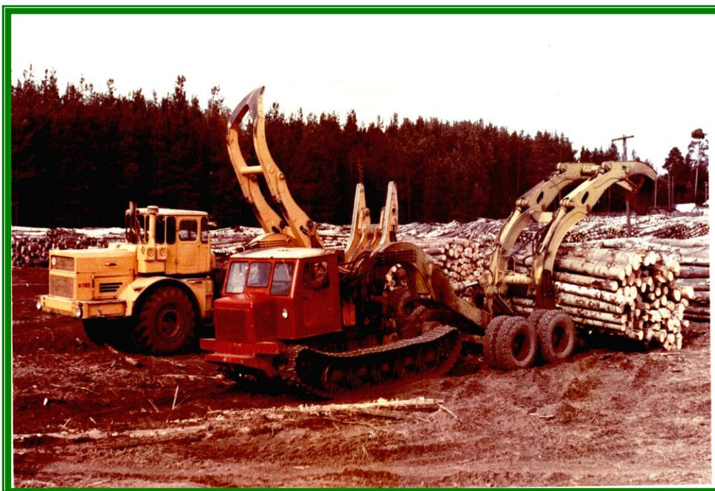
Агрегат имеет хорошую маневренность, достаточную проходимость и устойчивость, малое удельное давление на грунт, что позволяет ему хорошо вписываться в производственные процессы нижних складов, не имеющих специальной подготовки дорог.
